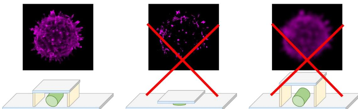
¿Cómo montar muestras “gruesas” preservando su estructura 3D, como por ejemplo, organoides o esferoides? Existen dispositivos comerciales, pero en el SCT de Microscopía e Imagen hemos puesto a punto un montaje de muestras utilizando los espaciadores adhesivos **Secure-Seal™** de Life Technologies.
